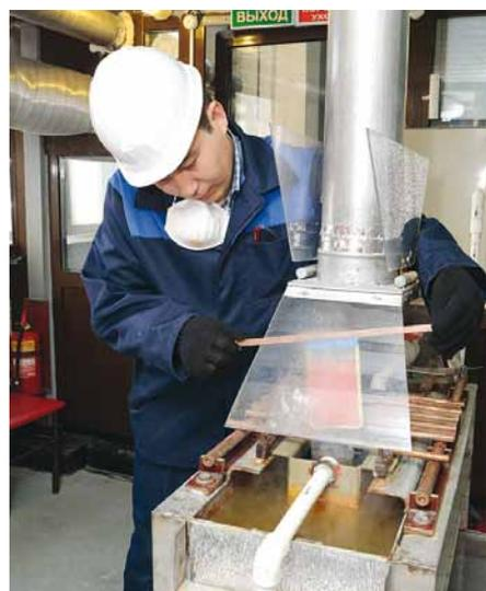
Основной продукт Казахмыса — катодная медь, полученная с помощью гидрометаллургической обработки
